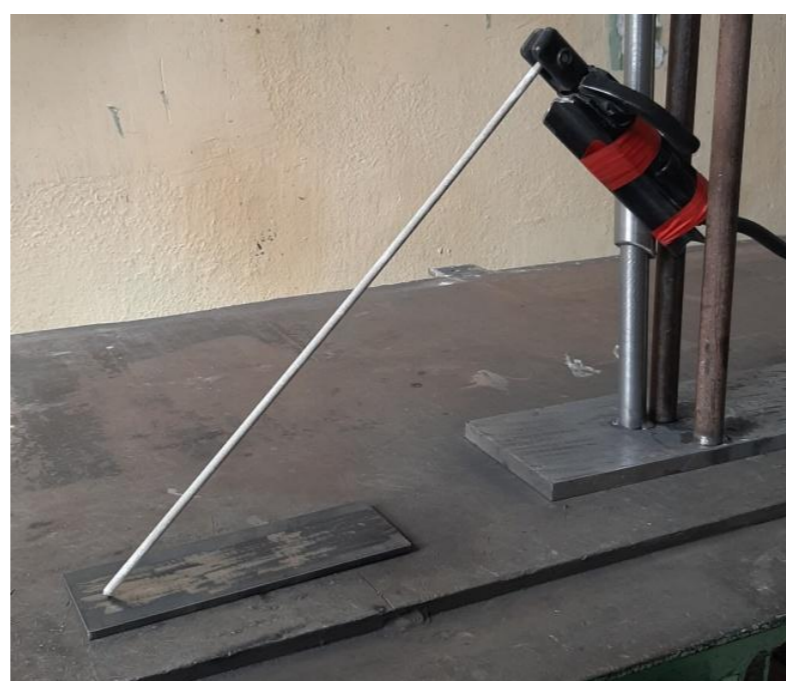
Рис. 3 Схема наплавки наклонным электродом
