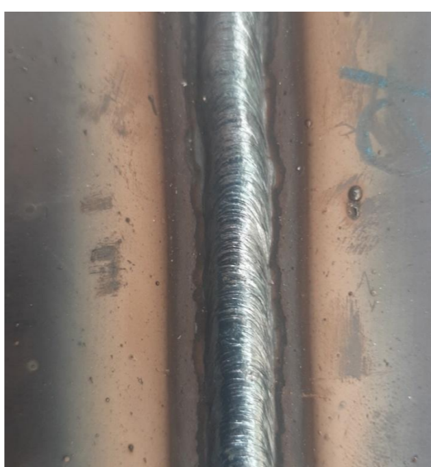
Рис. 4 Внешний вид наплавленного образца
