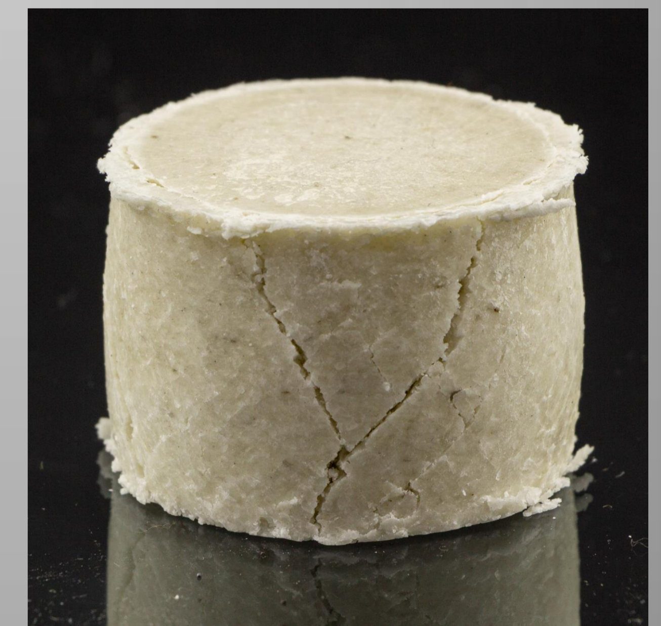
Рисунок 4. Разрушение цилиндрического образца, выполненного из порошка материала ПС 50/50 фракции 2,5 мм с пористостью P=0\% .
