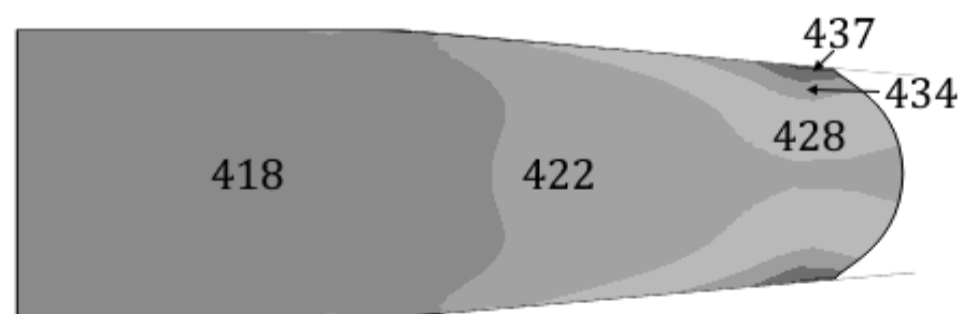
Поле распределения температуры при осадке цилиндрической заготовки из алюминиевого сплава при начальной температуре заготовки 400 °С
