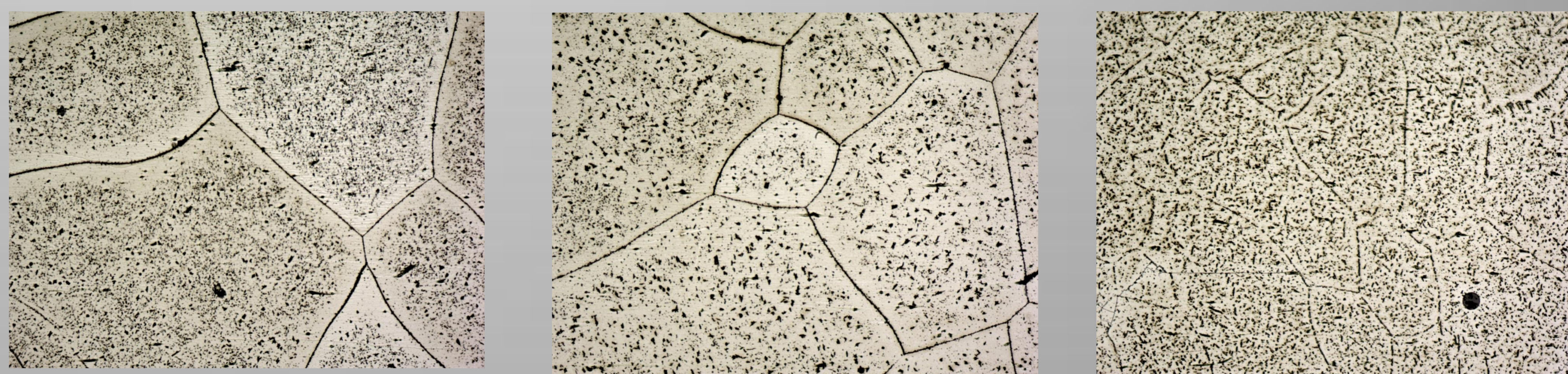
Рисунок 2. Структуры 1, 3 и 5 участков экспериментальных функционально-градиентных слитков с содержанием Al в функциональной части 11 %,масс.
