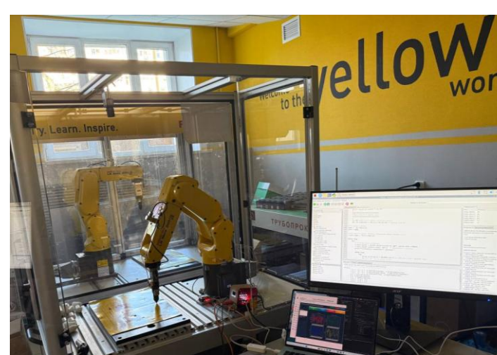
Промышленная ячейка Fanuc с датчиками и ПО для предиктивного анализа
