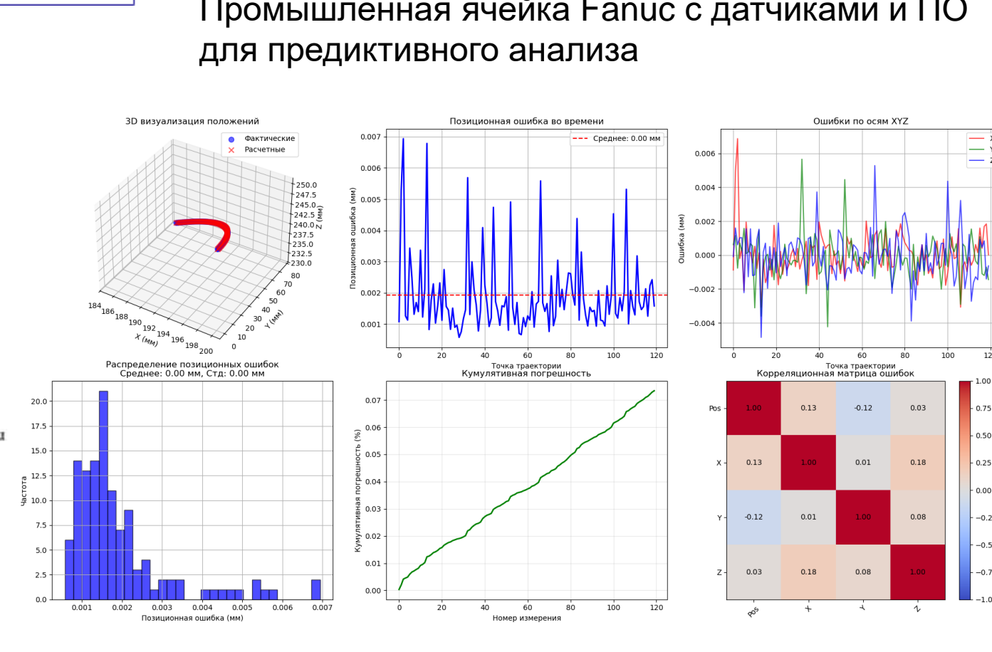
Модель отклонения координаты, обученная с использованием ARIMA
